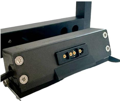
Setzen Sie den Deckel auf die Ladeinheit.
