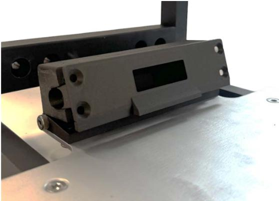
Entfernen Sie den Deckel der Ladehalterung.
