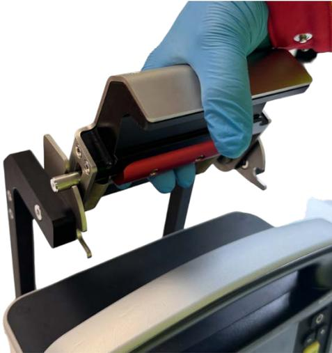
Schließen Sie den Bügel, bis er in der unteren Position einrastet.
