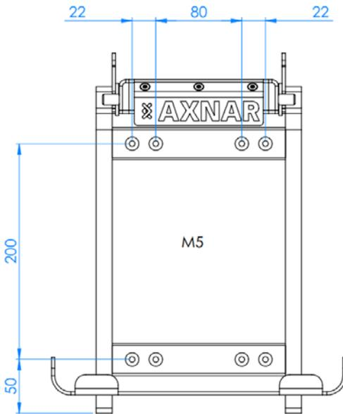
Für die Montage an der Wand, nutzen Sie das angezeigte Bohrbild.
