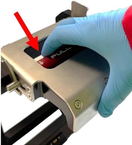
Öffnen Sie die den Verschluss durch Ziehen des roten Hebels.
