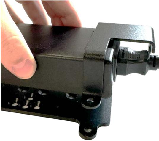
Setzen Sie das Netzteil mit den Klemmen auf die Grundplatte.
