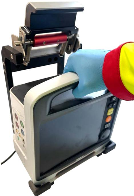
Setzen Sie den D60 / DX auf die Grundplatte.
