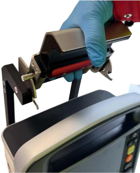
Für die Entnahmen öffnen Sie den Bügel und entnehmen Sie das Gerät aus der Halterung.
